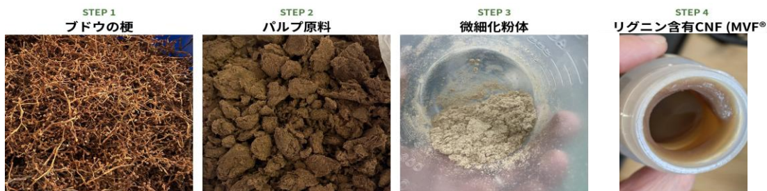
図 1. ブドウ梗から MVF®への製造プロセス(STEP1~STEP4)
